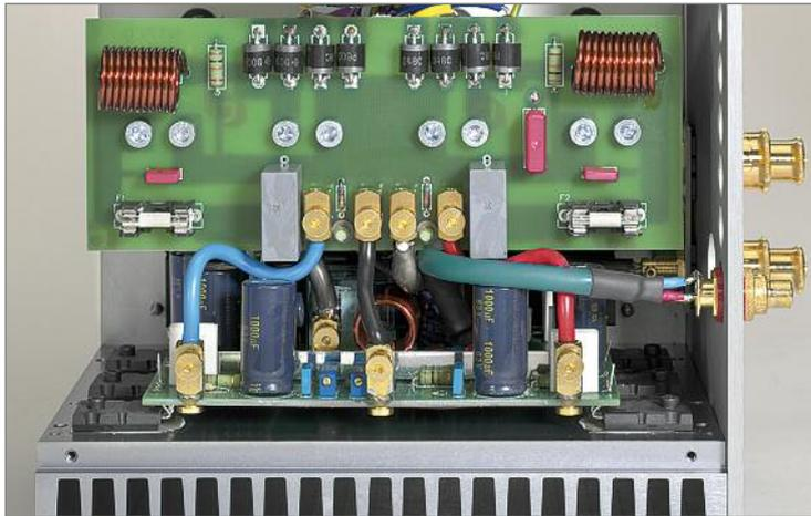
Die acht Dioden oben im Bild gibt es in der Version MkIV in neuer Qualität. In der Mitte ist am Boden der Endstufe die quer über die ganze Platine verlaufende Masseschiene zu sehen
