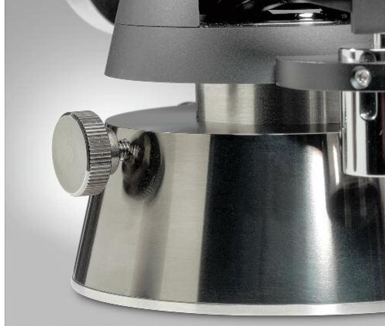
Bei gelöster Schraube lässt sich das Oberteil anheben und somit die Tonarmhöhe (VTA) korrekt einstellen
