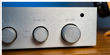
Ja, es gibt sie noch: Die Tape-Schleife ermöglicht bei der Integration an eines Tape decks oder einer Tonbandmaschine eine Hinterband-Kontrolle.
