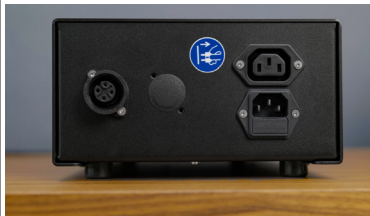
Die Rückseite des externen Netzteils: Der Kaltgeräte-Einbau-Netzstecker rechts unten dient der Verbindung zur Steckdose, über die darüber positionierte Buchse wird die Endstufe des Verstärkers gespeist. Durch die links sichtbare Vierpol-Buchse wird die verstärkerinterne Stromversorgung für die Vorstufe ans Netz gebracht.
