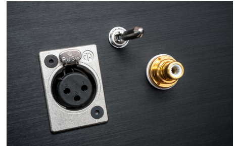
Die Endstufe bietet in der Standard-Ausstattung einen unsymmetrischen Input, der mit erstklassigen Cinch-Buchsen von WBT realisiert ist. Auf Wunsch wird zusätzlich ein symmetrischer XLR-Eingang eingebaut. Zur Umschaltung dient dann ein Kippschalter mit Sicherung: Erst wenn man den Kopf ein wenig herauszieht, lässt sich der Schalter umlegen.
