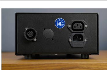
Die Rückseite des externen Netzteils: Der Kaltgeräte-Einbau-Netzstecker rechts unten dient der Verbindung zur Steckdose, über die darüber positionierte Buchse wird die Endstufe des Verstärkers gespeist. Durch die links sichtbare Vierpol-Buchse wird die verstärkerinterne Stromversorgung für die Vorstufe ans Netz gebracht.
