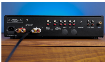
Die komplette Rückseite des RG 10 zeigt die analoge Vollausstattung dieses Verstärkers.
