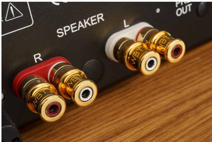
Der RG 14 erlaubt den Anschluss eines Lautsprecherpaares. Dafür bietet er vier exzellente Polklemmen aus der PVD-Plasmaprotect-Serie von WBT. Sie ermöglichen den Anschluss von Lautsprecherkabeln, die mit Bananensteckern oder Kabelschuhen konfektioniert sind.
