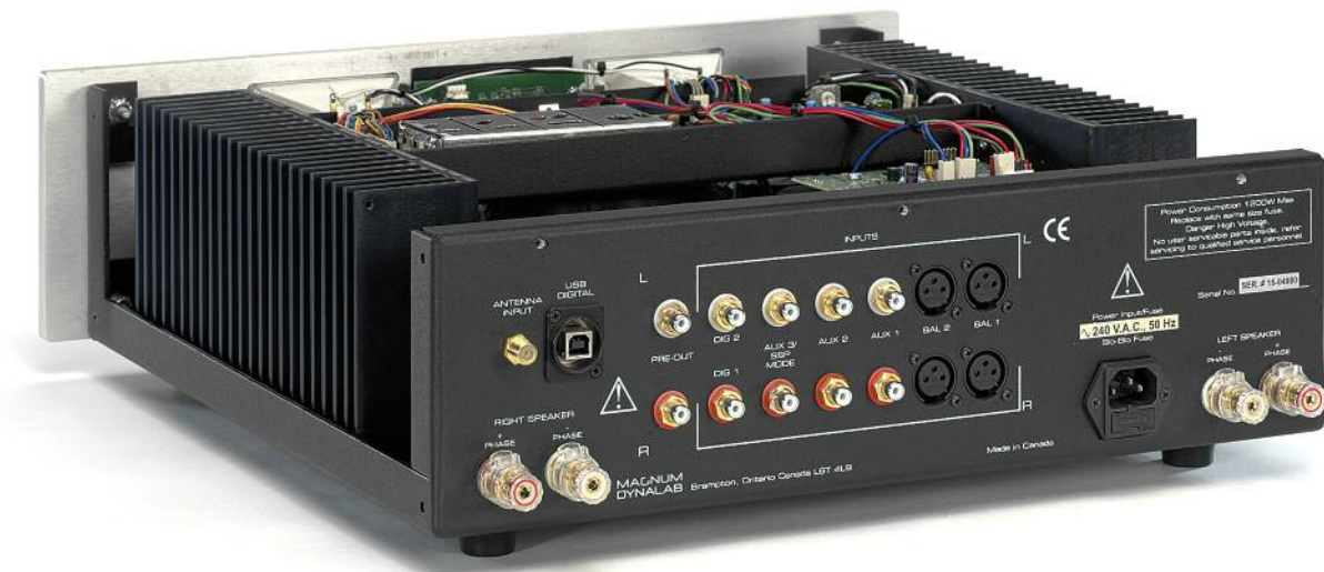
Anschlussfeld für die komplette Zentrale einer Heimanlage: links Antenne und USB-Eingang, rechts davon die RCA-Digitaleingänge sowie die analogen Eingänge als RCA- und XLR-Buchsen
