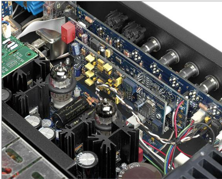
Ein Blick auf die Verstärkerstufe mit den beiden Röhren. Dahinter die Digitalsektion mit dem Burr Brown PCM1794 DAC
