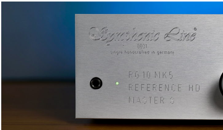
Die unbeschriftete Buchse könnte man fast übersehen - dabei handelt es sich hier um einen vollwertigen Kopfhörer-Ausgang.
