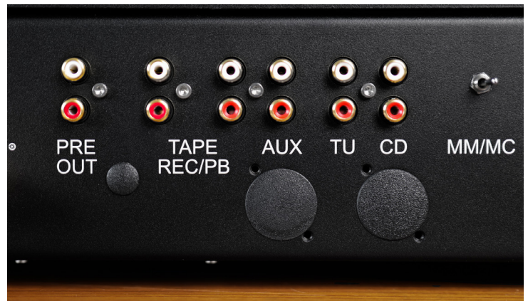
Die Input-Abteilung für analoge Line-Pegel-Zuspieler umfasst vier unsymmetrische Eingänge. Einer davon ist Teil einer klassischen Tape-Schleife - ein mittlerweile rares Ausstattungs-Feature. Die beiden größeren Blenden unter den Cinch-Buchsen deuten an: Dieser Verstärker ist schon vorbereitet für einen optionalen symmetrischen Eingang. Der Pre Out ermöglicht die Nutzen des RG 10 als reine Vorstufe.
