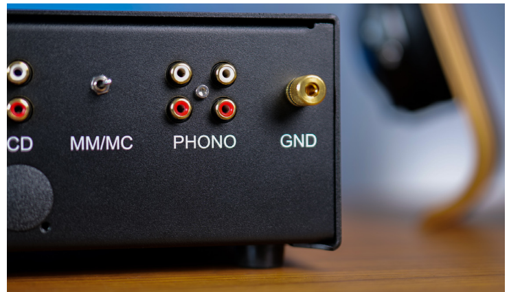
Vollbedienung für Vinylisten: Der RG 10 bietet gleich zwei Phono-Eingänge. Dementsprechend lassen sich zwei Plattenspieler anschließen. Die Analoglaufwerke können mit MM- oder MC-System bestückt sein: Mit dem Kippschalter stellt man das integrierte Phono-Modul auf die gewünschte Betriebsart um. Die rechts sichtbare Erdungsklemme verhindert die Entstehung einer Brummschleife. An diese Schraubklemme schließt man den entsprechenden Erdungsdraht des vom Plattenspieler kommenden Kabels an.
